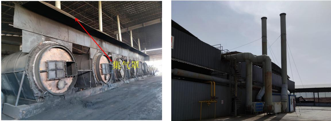
热解炉产污点设置集气罩
